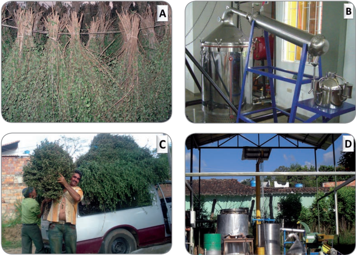
Figura 3-5. A. Plantas de prontoalivio ( Lippia alba , Fam. Verbenaceae) durante su secado. B. El destilador de aceites esenciales por arrastre con vapor, diseñado en el CENIVAM y utilizado en los experimentos con prontoalivio. C. La primera cosecha de plantas de prontoalivio en el proyecto experimental piloto en el Municipio de Socorro (Santander, Colombia). D. La planta extractora de aceites esenciales con capacidad de 1 m 3 , diseñada e instalada por el CENIVAM en el centro de acopio en Socorro. Proyecto financiado a través del Programa de apoyo a Cadenas Productivas del Ministerio de Agricultura y Desarrollo Rural. (Fotos: Camilo Durán).
