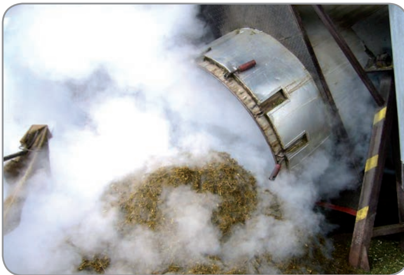
Figura 1-4. Residuos vegetales descargados del alambique después de la extracción del aceite esencial de hinojo ( Foeniculum vulgare , Fam. Apiaceae). Planta de extracción de aceites esenciales, Budapest, Hungría. (Foto: Elena E. Stashenko).
