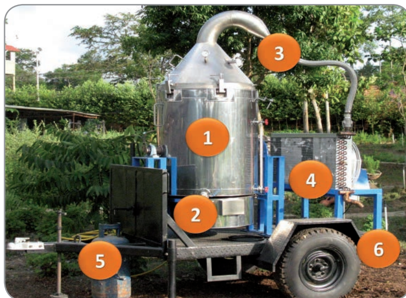
Figura 1-3. Destilador de aceites esenciales móvil con capacidad para 150 kg de material vegetal. Diseñado en el Centro de Investigación de Excelencia CENIVAM (UIS, Bucaramanga) para la extracción de aceites esenciales por destilación con agua-vapor e hidrodestilación. 1. Cuerpo del destilador donde se depositan el agua y, en una canasta, el material vegetal; 2. Quemador de gas para calentar el agua; 3. Cuello de ganso (o cisne ); 4. Condensador, sistema de enfriamiento tipo radiador; 5. Cilindro con gas; 6. Plataforma para la ubicación y transporte del destilador. (Foto: Elena E. Stashenko)
