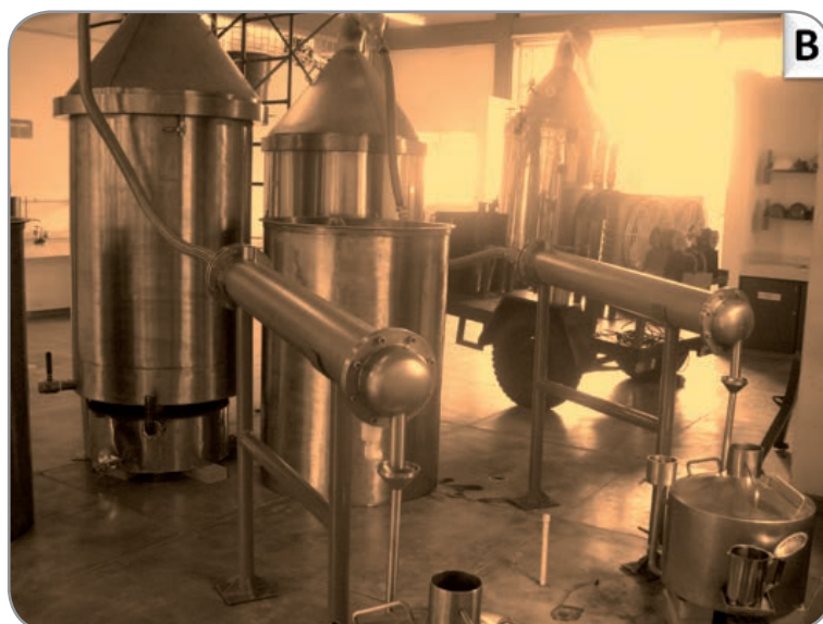
Figura 5-10. A. Diseño de un destilador para la obtención de aceites esenciales. B. Destiladores construidos, en el proceso de su montaje y pruebas, en el Complejo Industrial Piloto del CENIVAM (UIS, Bucaramanga). (Foto: Elena E. Stashenko ).
