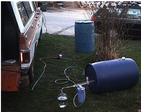
Configuración que muestra la parte trasera del camión, bomba, filtro, Vortrap y dos contenedores de captura
