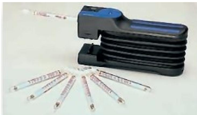
Figura 5. Medición local del ozono ambiental. Tubos detectores de ozono Dräger y bomba de aspiración manual Accuro. Tomado de la ref. [4].
